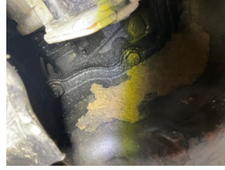
Motor, Motor > Yağ Kaçağı
