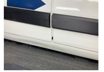
Marşbiyel, sağ, Marşbiyel, sağ > Hasarlı
