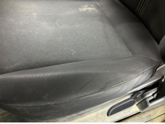
Döşemeler/Kapaklar, Döşemeler/Kapaklar > Yakıcı Madde Ile Zarar Görmüş
