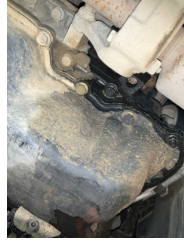
Motor, Motor > Yağ Kaçağı
