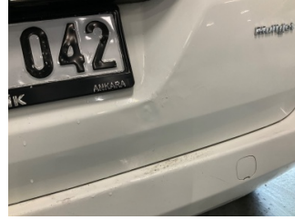
Bagaj kapağı/kapısı, Bagaj kapısı > Standart Dışı Onarım
