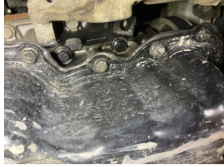
Motor, Motor > Yağ Kaçağı
