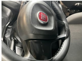
Direksiyon sistemi, Direksiyon simidi > Deforme Olmuş
