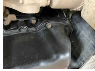
Motor, Motor > Yağ Kaçağı
