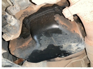
Motor, Motor > Yağ Kaçağı
