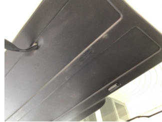
Döşemeler/Kapaklar, Bagaj kapağı, iç döşemesi > Çizik
