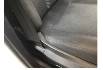
Koltuklar, ön, Koltuk, sağ ön > Deforme Olmuş
