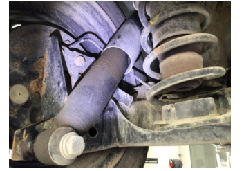
Arka aks, Amortisör, arka sol > Yağ Kaçağı
