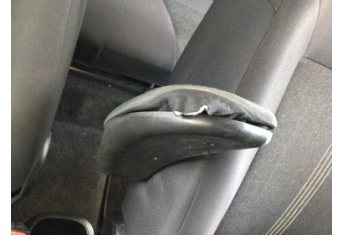
Koltuklar, ön, Kol dayaması > Hasarlı
