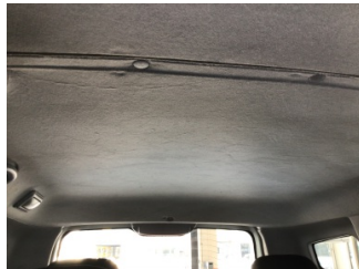
Döşemeler/Kapaklar, Tavan döşemesi > Deforme Olmuş
