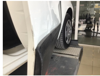
Kapı, sağ ön, Kapı, sağ ön > Hasarlı
