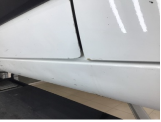
Kapı, sol ön, Kapı, sol ön > Ezik
