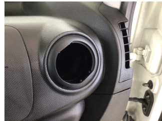
Kalorifer/Klima, Havalandırma ızgarası > Sökülmüş-Yok
