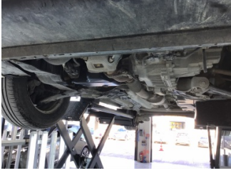
Motor, Alt muhafaza > Sökülmüş-Yok
