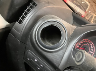
Kalorifer/Klima, Havalandırma ızgarası > Hasarlı
