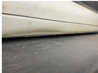
Marşbiyel, sağ, Marşbiyel, sağ > Hasarlı
