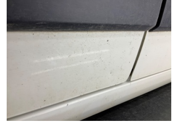
Kapı, sol ön, Kapı, sol ön > Ezik
