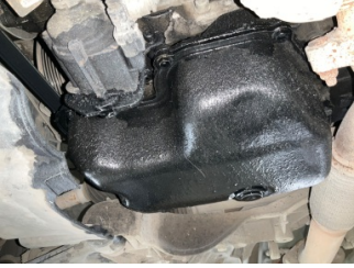
Motor, Motor > Yağ Kaçağı
