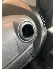
Kalorifer/Klima, Havalandırma ızgarası > Hasarlı
