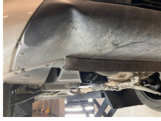
Tampon, ön, Ön tampon ızgarası > Ezik
