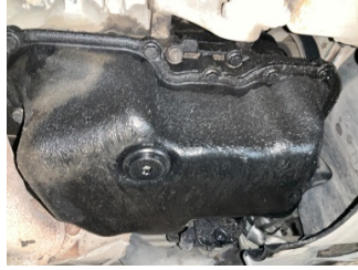
Motor, Motor > Yağ Kaçağı
