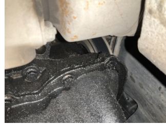
Motor, Motor > Yağ Kaçağı
