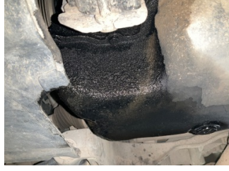
Motor, Motor > Yağ Kaçağı
