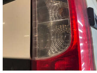
Arka lambalar, Arka lamba camı, sağ > Çatlak
