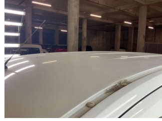
Tavan, Tavan > Dolu Hasarı
