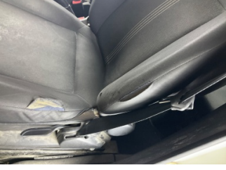
Döşemeler/Kapaklar, Döşemeler/Kapaklar > Hasarlı
