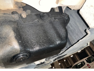
Motor, Motor > Yağ Kaçağı
