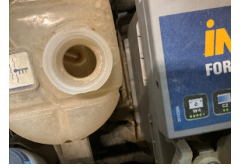
Motorsoğutması, Soğutma sıvısı > Eksik
