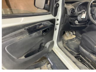
Döşemeler/Kapaklar, Döşemeler/Kapaklar > Deforme Olmuş
