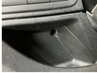
Döşemeler/Kapaklar, Döşemeler/Kapaklar > Sabitlemesi Hatalı
