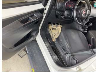
Döşemeler/Kapaklar, Döşemeler/Kapaklar > Deforme Olmuş
