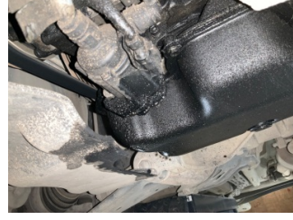
Motor, Motor > Yağ Kaçağı
