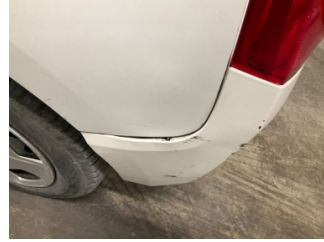
Tampon, arka, Arka tampon > Sabitlemesi Hatalı
