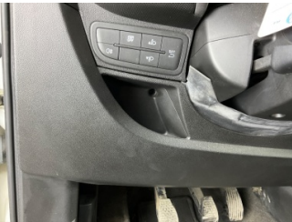
Döşemeler/Kapaklar, iç döşemesi, sol > Sabitlemesi Hatalı
