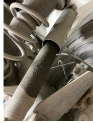
Arka aks, Amortisör, arka sağ > Yağ Kaçağı
