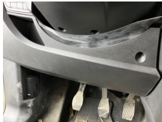
Döşemeler/Kapaklar, iç döşemesi, sol > Sabitlemesi Hatalı
