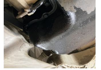
Motor, Motor > Yağ Kaçağı
