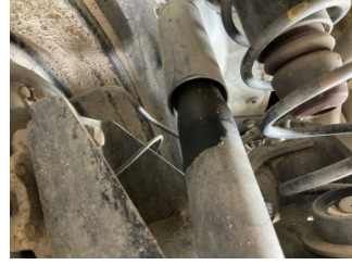
Arka aks, Amortisör, arka sol > Yağ Kaçağı
