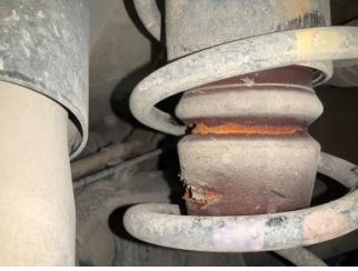
Arka aks, Amortisör, arka > Hasarlı
