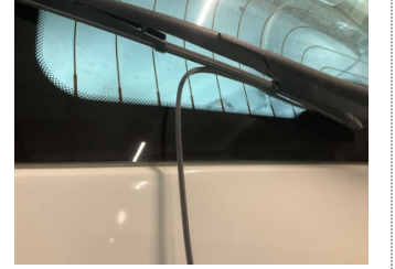
Cam yıkama/silme sistemi, Silecek arka > Deforme Olmuş
