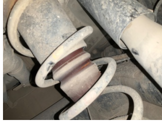
Arka aks, Amortisör, arka > Hasarlı
