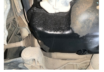
Motor, Motor > Yağ Kaçığı
