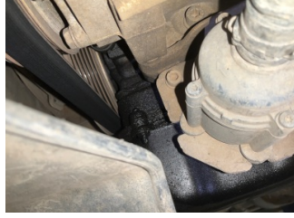
Motor, Motor > Yağ Kaçağı
