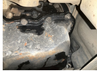
Motor, Motor > Yağ Kaçağı
