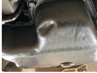
Motor, Yağ karteri > Hasarlı
