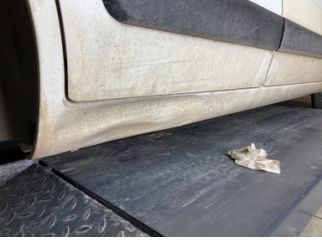
Marşbiyel, sağ, Marşbiyel, sağ > Hasarlı
