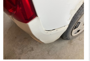
Tampon, arka, Arka tampon > Sabitlemesi Hatalı
