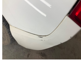
Tampon, arka, Arka tampon > Sabitlemesi Hatalı
