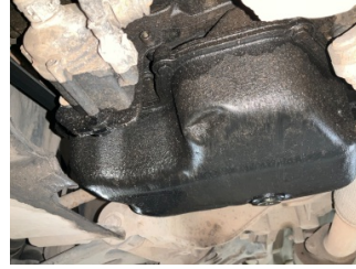
Motor, Motor > Yağ Kaçağı
