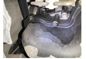
Motor, Motor > Yağ Kaçağı
