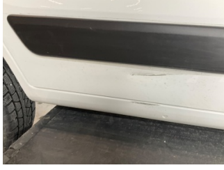
Kapı, sağ arka, Kapı, sağ arka > Ezik
