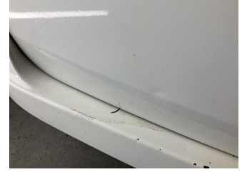
Bagaj kapağı/kapısı, Bagaj kapısı > Ezik
