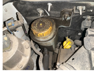
Direksiyon sistemi, Hidrolik yağı kabı > Yağ Kaçağı
