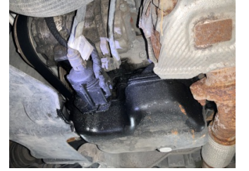
Motor, Motor > Yağ Kaçağı
