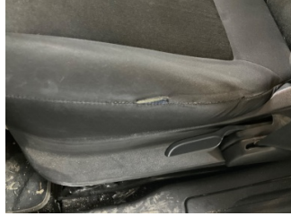
Koltuklar, ön, Koltuk, sol ön > Dikişleri Açılmış
