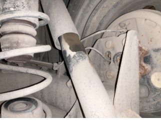
Arka aks, Amortisör, arka sağ > Yağ Kaçağı
