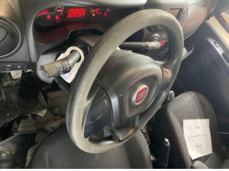
Direksiyon sistemi, Direksiyon simidi > Deforme Olmuş
