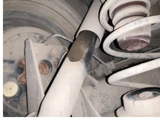
Arka aks, Amortisör, arka sol > Yağ Kaçağı
