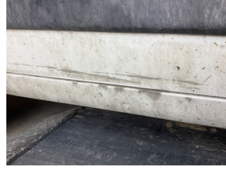
Kapı, sağ arka, Kapı, sağ arka > Ezik
