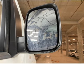
Dikiz aynası, sağ, Dış dikiz aynası > Kırılmış
