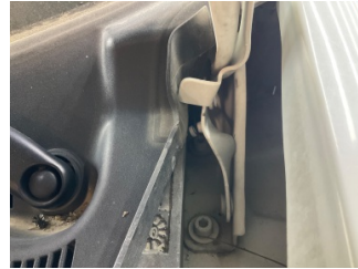
Motor kaputu, Dayama çubuğu/Amortisör > Hasarlı
