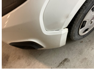
Tampon, ön, Ön tampon > Sabitlemesi Hatalı
