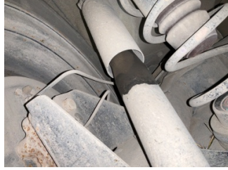
Arka aks, Amortisör, arka > Yağ Kaçağı
