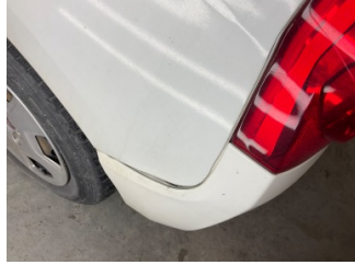
Tampon, arka, Arka tampon > Sabitlemesi Hatalı
