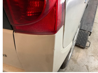
Tampon, arka, Arka tampon > Sabitlemesi Hatalı
