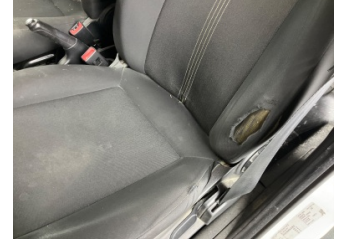
Koltuklar, ön, Koltuk, sol ön > Deforme Olmuş
