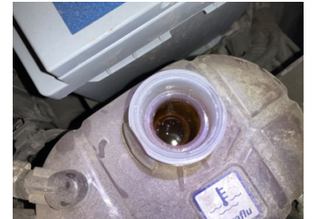
Motorsoğutması, Soğutma sıvısı > Kirlenmiş
