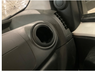
Kalorifer/Klima, Havalandırma ızgarası > Kırılmış
