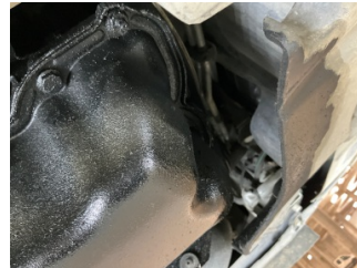
Motor, Motor > Yağ Kaçağı
