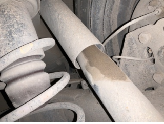
Arka aks, Amortisör, arka > Yağ Kaçağı
