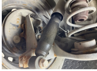
Arka aks, Amortisör, arka sol > Yağ Kaçağı
