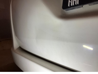
Bagaj kapağı/kapısı, Bagaj kapısı > Ezik
