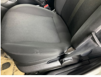
Döşemeler/Kapaklar, Döşemeler/Kapaklar > Deforme Olmuş
