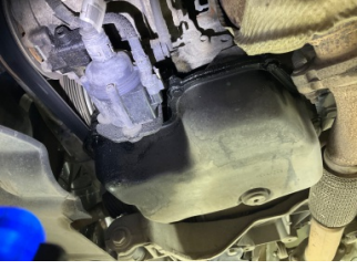
Motor, Motor > Yağ Kaçağı
