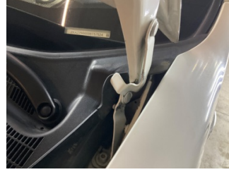
Motor kaputu, Mentese > Hasarlı
