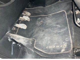
Taban, Paspaslar > Hasarlı
