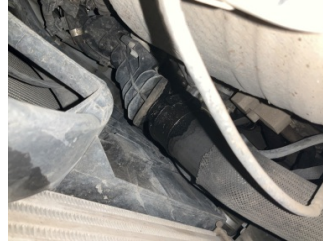
Motorsoğutması, Hortumlar > Yağ Kaçağı
