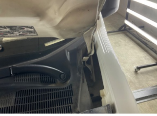
Motor kaputu, Menteşe > Hasarlı
