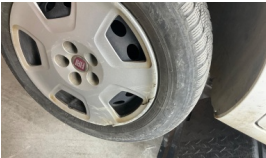
Jant kapağı seti > Hasarlı
