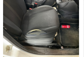
Koltuklar, ön, Koltuk döşemesi, sağ ön > Hasarlı
