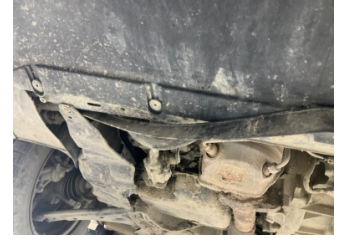
Tampon, ön, Tampon koruyucu orta > Hasarlı
