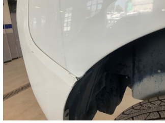
Çamurluk, sağ arka, Çamurluk, sağ arka > Ezik
