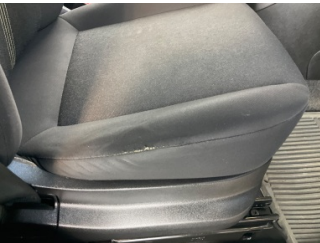
Koltuklar, ön, Koltuk döşemesi, sağ ön > Hasarlı
