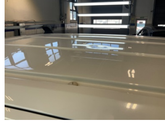
Tavan, Tavan > Dolu Hasarı
