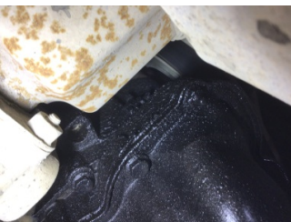
Motor, Triger zinciri kapağı > Yağ Kaçağı
