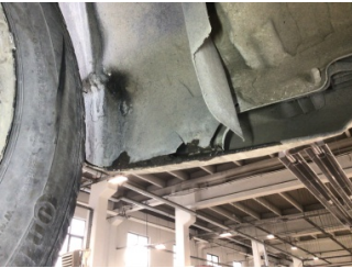
Motor, Alt muhafaza > Hasarlı
