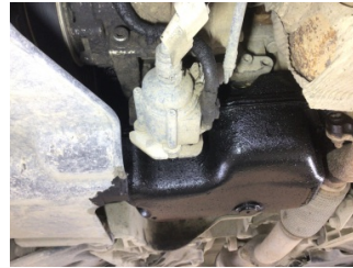
Motor, Yağ karteri > Yağ Kaçağı
