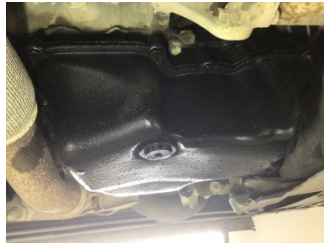
Motor, Yağ karteri > Yağ Kaçağı
