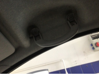
Döşemeler/Kapaklar, Tavan döşemesi > Deforme Olmuş
