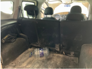
Döşemeler/Kapaklar, Pandizot > Sökülmüş-Yok
