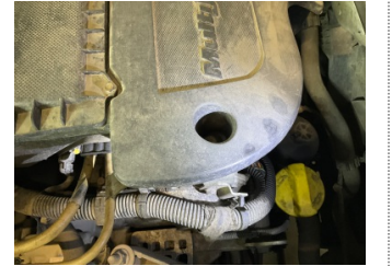
Motor, Motor üst kapağı, plastik > Sabitlemesi Hatalı
