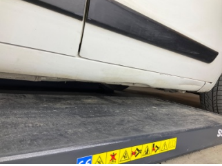
Marşbiyel, sağ, Marşbiyel, sağ > Hasarlı
