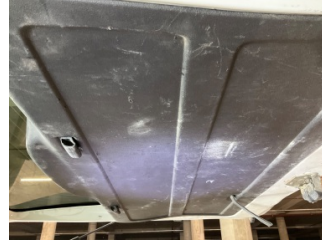
Döşemeler/Kapaklar, Döşemeler/Kapaklar > Çizik
