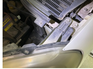
Farlar, Far bağlantı ayağı, sol > Hasarlı
