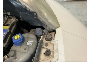
Farlar, Far bağlantı ayağı, sol > Hasarlı
