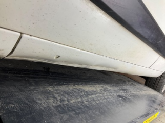
Marşbiyel, sol, Marşbiyel, sol > Hasarlı
