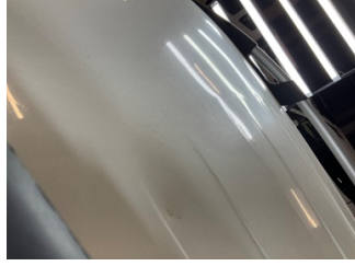
Tavan, Tavan > Dolu Hasarlı
