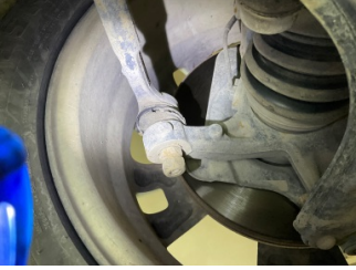
Direksiyon sistemi, Rot kolu/Rot başı, sol > Hasarlı
