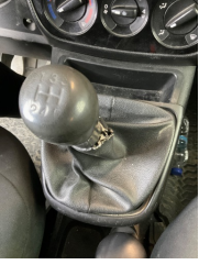
Şanzıman, Vites körüğü > Hasarlı
