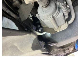
Motor, Motor > Yağ Kaçağı
