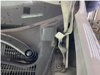
Motor kaputu, Menteşe > Hasarlı
