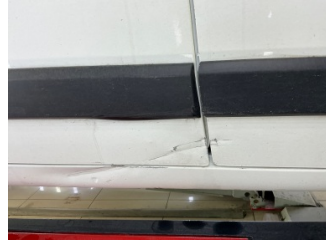
Kapı, sağ arka, Kapı, sağ arka > Hasarlı
