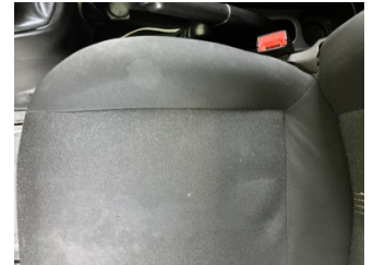
Döşemeler/Kapaklar, Döşemeler/Kapaklar > Yakıcı Madde Ile Zarar Görmüş
