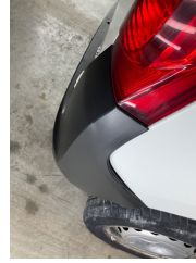
Tampon, arka, Arka tampon > Sabitlemesi Hatalı
