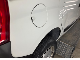
Çamurluk, sağ arka, Çamurluk, sağ arka > Ezik
