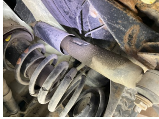
Arka aks, Amortisör, arka sağ > Yağ Kaçağı
