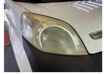
Farlar, Far camı, sağ > Deforme Olmuş
