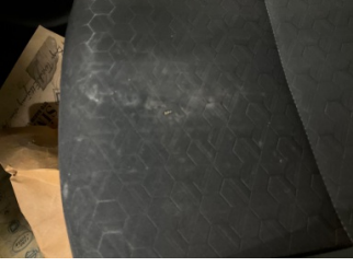
Koltuklar, ön, Koltuk ısıtması, sağ ön > Yakıcı Madde ile Zarar Görmüş
