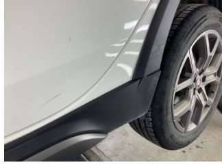
Marşbiyel, sol, Marşbiyel plastiği, sol > Kırılmış
