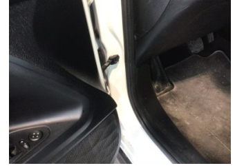
Kapı, sol ön, Kapı gergisi > Ses Yapıyor
