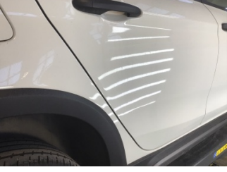
Kapı, sağ arka, Kapı, sağ arka > Ezik
