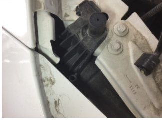
Farlar, Far bağlantı ayağı, sağ > Hasarlı
