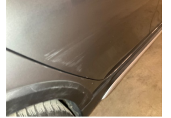
Kapı, sağ arka, Kapı, sağ arka > Çizik
