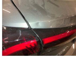
Bagaj kapağı/kapısı, Bagaj kapısı > Ezik
