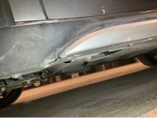
Marşbiyel, sol, Marşbiyel plastiği, sol > Hasarlı
