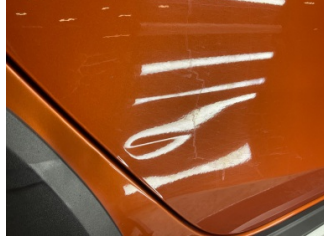
Kapı, sağ arka, Kapı, sağ arka > Ezik
