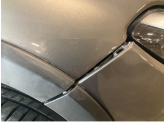
Tampon, ön, Ön tampon > Sabitlemesi Hatalı
