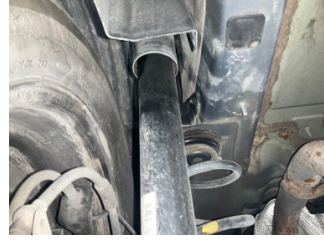
Arka aks, Amortisör, arka > Yağ Kaçağı
