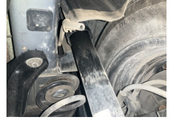
Arka aks, Amortisör, arka > Yağ Kaçağı
