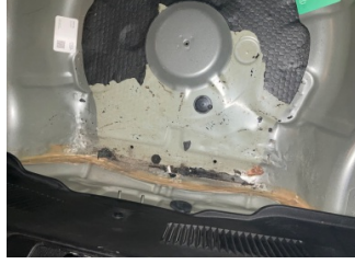
Arka bölüm, Bagaj havuzu > Hasarlı
