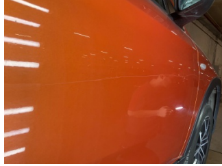
Kapı, sağ ön, Kapı, sağ ön > Çizik
