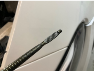
Motor, Yağ seviyesi > Eksik
