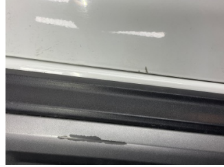
Marşbiyel, sağ, Marşbiyel plastığı, sağ > Çizik
