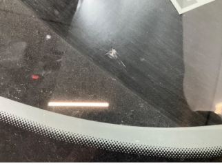
Camlar, Ön cam > Hasarlı
