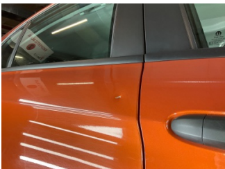
Kapı, sağ arka, Kapı, sağ arka > Ezik
