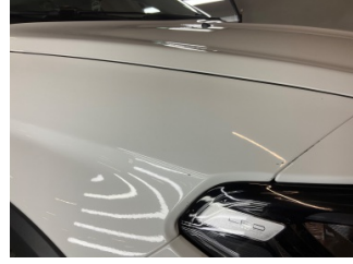
Çamurluk, sağ, Çamurluk, sağ > Taş İzi
