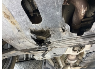
Motor, Alt muhafaza > Hasarlı
