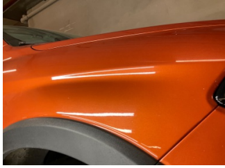
Çamurluk, sağ, Çamurluk, sağ > Taş Izi
