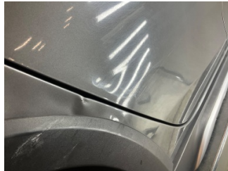
Kapı, sağ arka, Kapı, sağ arka > Ezik
