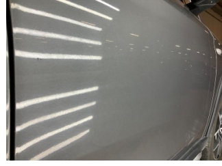
Kapı, sağ ön, Kapı, sağ ön > Çizik
