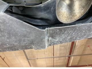
Tampon, arka, Spoiler > Standart Dışı Onarım
