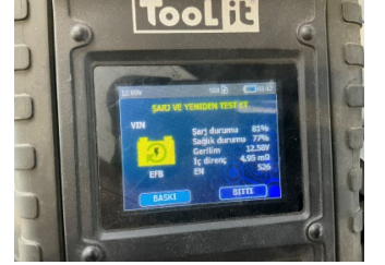
Elektrik donanımı/Pano, Akü > Test Sonucu
