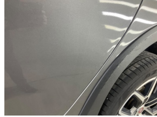
Kapı, sol arka, Kapı, sol arka > Çizik
