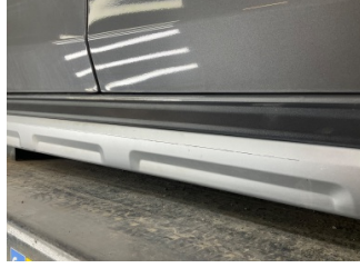
Marşbiyel, sağ, Marşbiyel plastığı, sağ > Çizik
