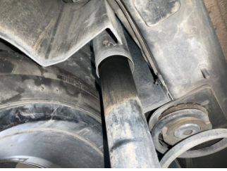
Arka aks, Amortisör, arka sol > Yağ Kaçağı
