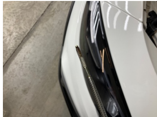
Motor, Yağ seviyesi > Eksik
