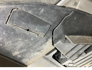
Tampon, ön, Tampon koruyucu orta > Hasarlı
