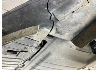
Tampon, ön, Tampon koruyucu orta > Hasarlı
