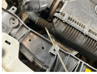
Motor, Yağ seviyesi > Eksik
